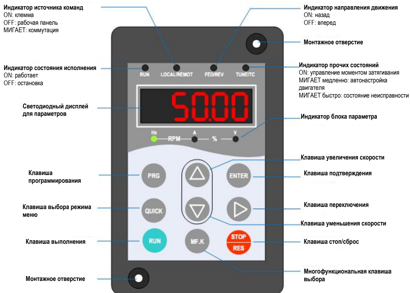
Рис. 4-1. Детали рабочей панели
