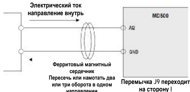
Рис. 3-12. Способ проводки для использования с аналоговым входом 2
