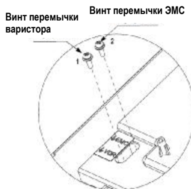
Рис. 3-8. Винт перемычки ЭМС и винт перемычки варистора.
